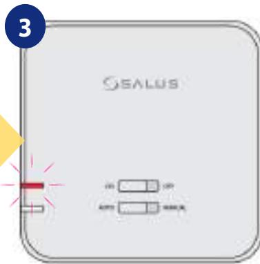
Pokud chcete spárovat zařízení, ujistěte se, že je přijímač odpojený od napájení a spínače na něm jsou v poloze AUTO a ON. Následně připojte přijímač k zdroji napájení a počkejte, dokud nezačne červená dioda nepřetržitě svítit.
